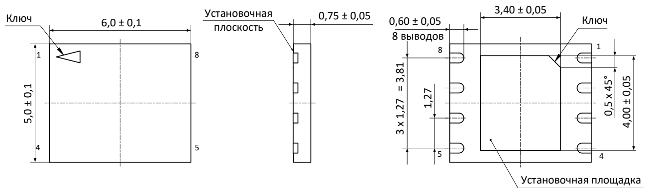
Рисунок 4 – Микросхема в корпусе DFN8 5×6×0,75 (1,27)
